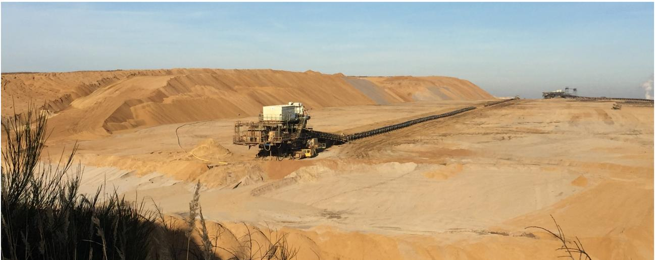
Abbildung 7, Große Mengen standfestes Material auf der überhöhten Innenkippe; ANSEV/EB, 2018
