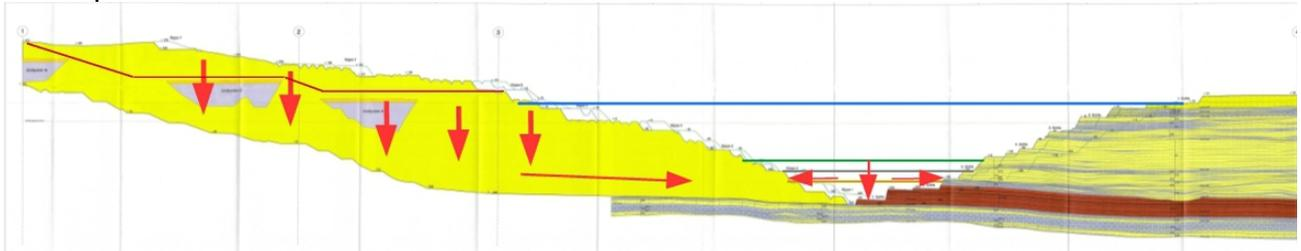
Abbildung 3: Längenschnitt im Bereich der nördlichen Randböschung, Quelle: RWE Hauptbetriebsplan 2021 bis 2024, Anlage Nr.: 3.4, Bearbeitung: ANSEV/BK
