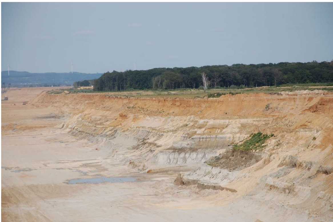
Abb. 3: Tagebaukante zwischen der NW- Ecke des Hambacher Forstes und dem Merzenicher Erbwald am 7. Juni 2020. Auslaufendes Grundwasser im Bereich schluffiger Schichten bildet große Lachen auf der ersten Sohle des Tagebaus. Vor dem Aufnahmezeitpunkt gab es über 4 Wochen keinen Niederschlag, der diese offenen Wasserflächen hätte erzeugen können. Foto: Initiative 3 Rosen e.V.
